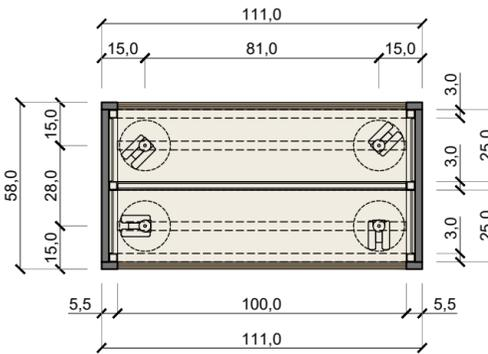
SEZIONE ORIZZONTALE CC' (con ruote)
