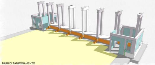
MURI DI TAMPONAMENTO E MURETTI DI APPOGGIO GRANONI E SOLAIO
